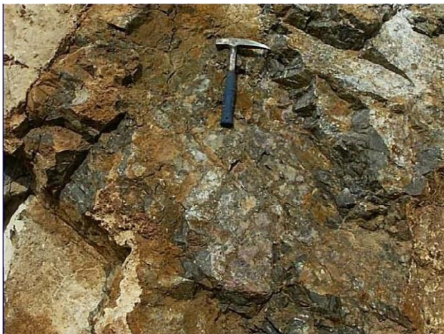
Figura 27. Detalles de cómo los cristales violetas de fluorita tapizan planos de rotura y rellenan fisuras y huecos a manera de cemento de brecha
