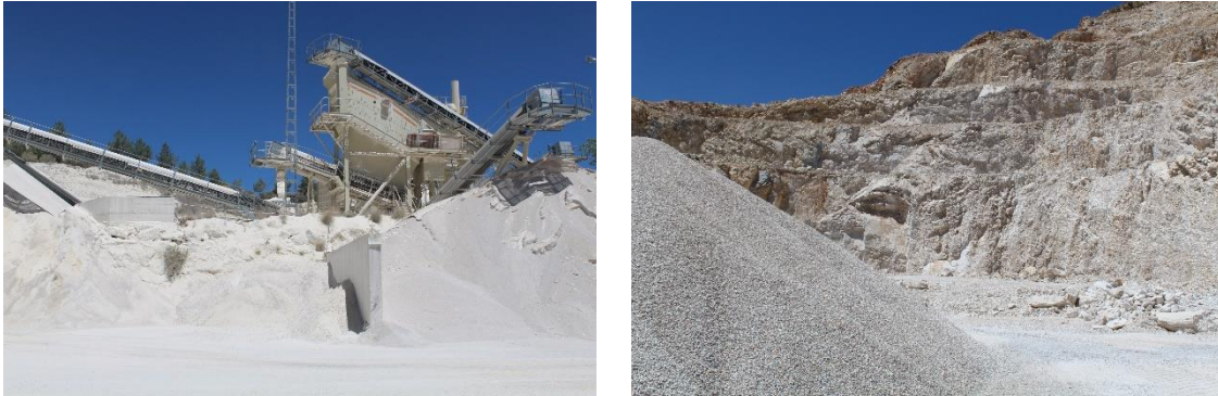
Figura 19. Imagen de la planta dentro de la propia cantera de La Lancha, en Jódar (izq.), con material acopiado y clasificado tras haber sido machacado previamente y frente de extracción de la caliza (dcha).
