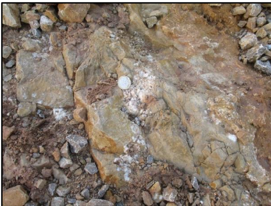
Figura 23. Mineralización encajada en caliza
