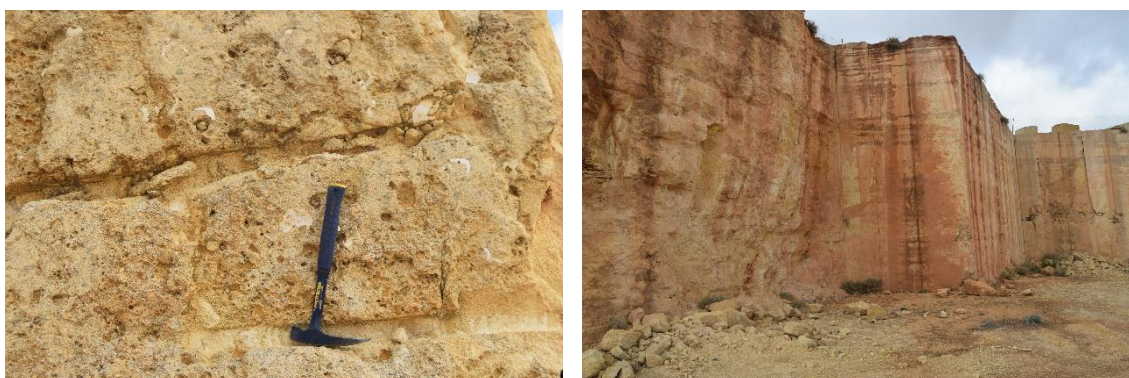
Figura 14. Cantera de calcarenita en Alcalá La Real (izquierda) detalle de las calcarenitas con abundantes restos de conchas y (derecha) frentes de explotación.
